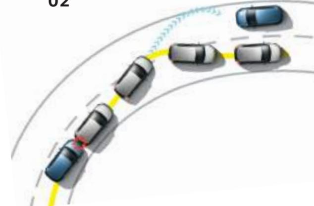
當汽車與障礙物碰撞後，稱為一次碰撞，乘員與車內構件再次碰撞，稱為二次碰撞。Volkswagen 的防護氣囊能在二次碰撞前迅速打開，可減輕駕乘者因慣性作用力所產生的二次碰撞傷害程度。
