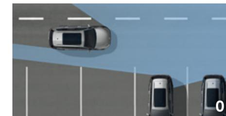
1. Front Assist 車前碰撞預警系統 (含 AEB 自動輔助緊急煞車功能) 及 ACC 主動式固定車距巡航系統，其煞車功能有效作用之情形，限於：其他車輛位於前雷達正前方適當距離且環境狀況良好令雷達得以順利運作時。請注意，在繁忙行車、彎道、山路、隧道之一般道路、行車速度緩慢、與前方車距過短，或是天候易對雷達造成干擾 (如下雨、陽光過強) 等狀況下，該系統將不會發生作用。
